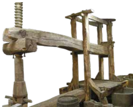
Un pressoir à longue étreinte pour le cidre. Les poutres maîtresses se nomment « brebis » et « béliet » et ont une longueur de 9 m. La taille était si imposante qu'elle obligeait à construire un bâtiment à sa mesure, en forme de L.
